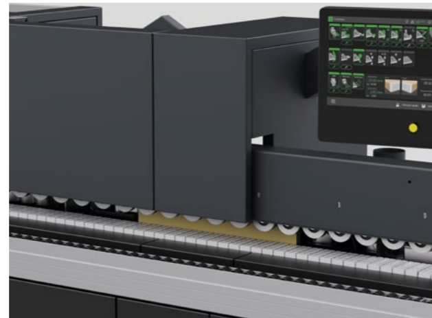
Beheiztes Einlauflineal: Das beheizte Einlauflineal bringt das Plattenmaterial vor der Bearbeitung auf optimale Temperatur. Das verbessert die Haftung des Klebers und sorgt für gleichbleibende Qualität – auch bei Temperaturschwankungen in der Werkstatt oder bei kalter Lagerung. KXX/03
