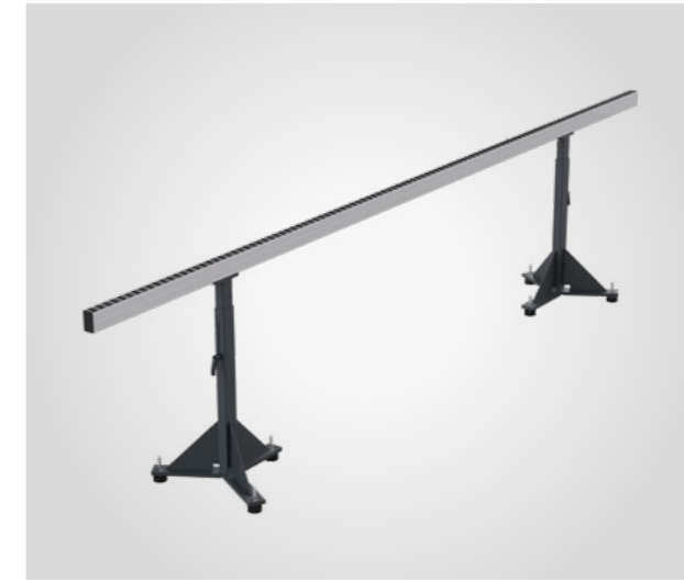
Zusätzliche Rollenbahn: Erleichtert die ergonomische Handhabung großer oder schwerer Werkstücke und verhindert ein Durchbiegen des Materials außerhalb der Maschine. KXX/35
