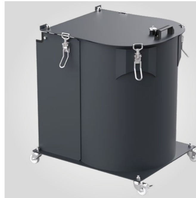
PUR-Box: Unsere PUR-Box verlangsamt per druckluftgestütztem Trocknungsverfahren das Aushärten des PUR-Leims und verlängert die Verarbeitungszeit auf bis zu 7 Tage, bevor eine Reinigung nötig wird – ideal bei regelmäßiger PUR-Verarbeitung. P01
